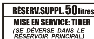
Figure 2-10 - Près de la tirette de transfert si le réservoir optionnel est installé.
