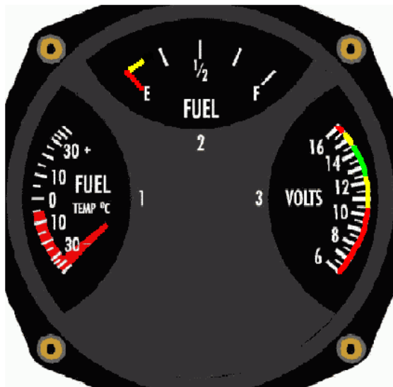
Exemple de l'instrument Westach "3 infos", sans OAT
